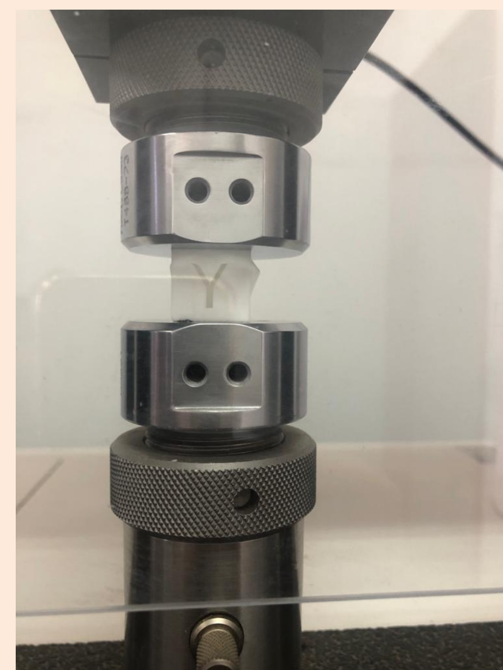
Fig. 5: Cubo siendo sometido a ensayo en máquina INSTRON
