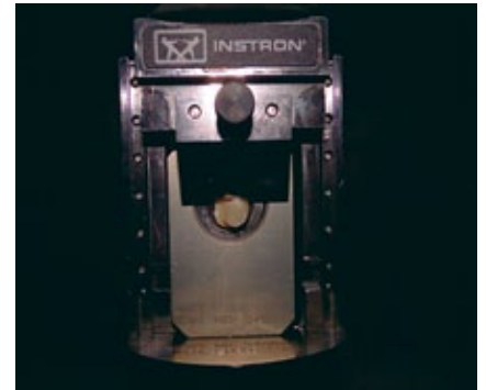
Figura 19: Prueba de fuerza de cizalla con instron.
