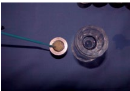
Figura 17: Aplicación de adhesivo.
