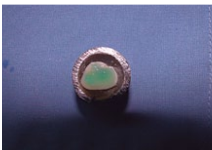
Figura 14: Grabado Acido con Ácido orto fosfórico al 37% durante 15 segundos.
