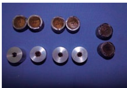
Figura 13: Cilindros metálicos con acrílico rotulados del 1 al 10. (probetas).
