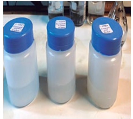
Figura 9: Colocación de 30 probetas de giómeros en agua desionizada, para medir la liberación de fluor.
