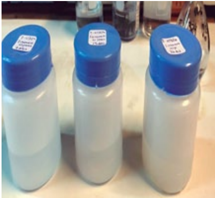
Figura 13: Colocación de 30 probetas de iómeros en agua desionizada, para medir la liberación de fluor.
