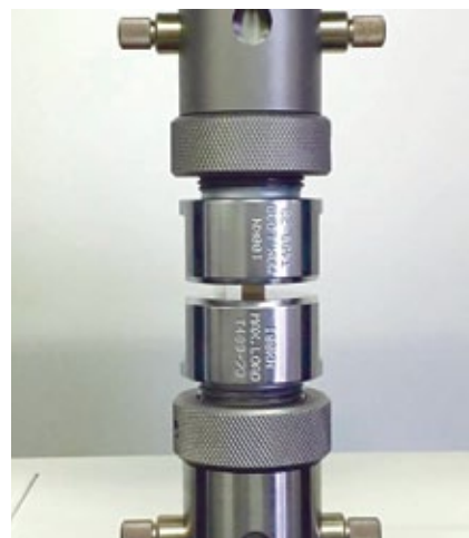
Figura 8: Ensayo de resistencia diametral. Experiencia de laboratorio.
